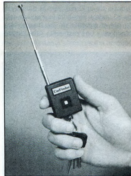
El «buscacoche» (CarFinder™) es un dispositivo original que permite la localización del coche en las grandes zonas de aparcamiento. Con un alcance de unos 250 m, el equipo incluye un transmisor sujeto al llavero, un receptor y los componentes necesarios para que suene un bocinazo y se enciendan los intermitentes del vehículo en respuesta a la señal transmitida (Foto cortesía de Design Tech International Inc.).
