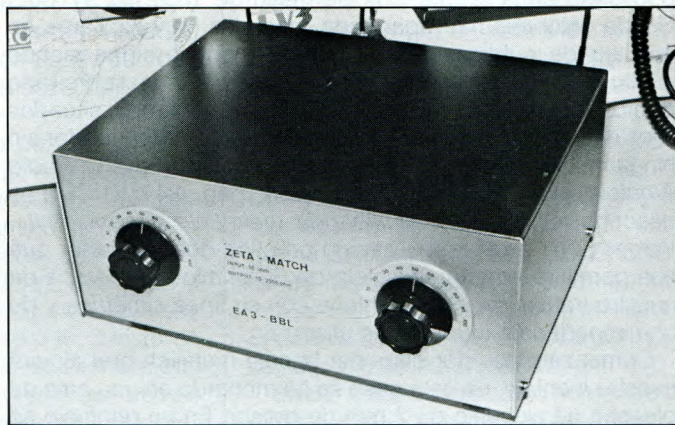
Figura 7. El acoplador terminado alojado en la caja de aluminio.
