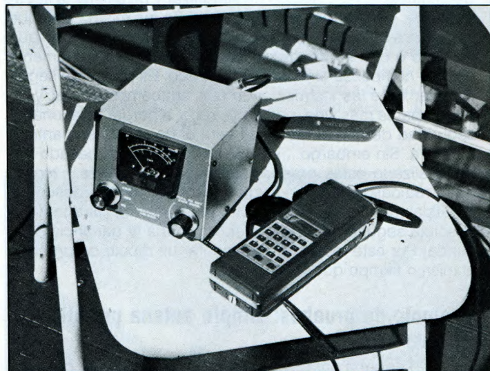
El instrumental de pruebas no es nada complicado: simplemente un buen medidor de ROE y un pequeño transceptor con potencia suficiente para provocar en el medidor la lectura a tope de escala en «directa»
