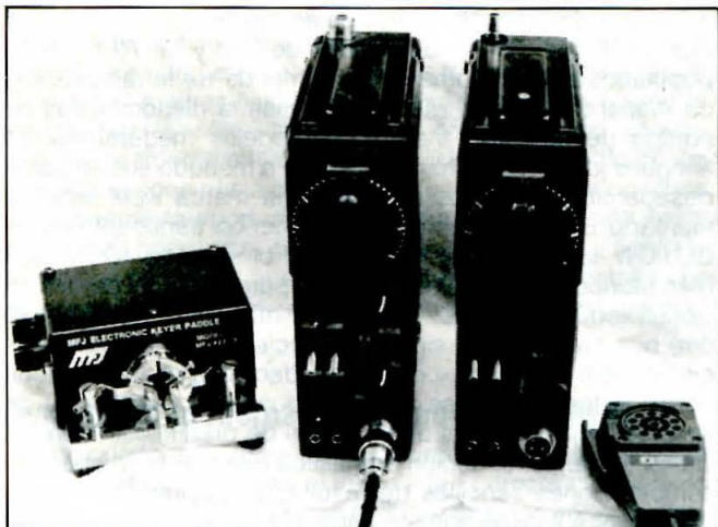
Figura 4. Ejemplo real de una estación muy asequible para trabajar vía satélite. Transceptores BLUICW de 2 m y 70 cm con aparatos económicos de segunda mano a los que se suma un amplificador de RF y un preamplificador. Completan la estación las antenas de 2 m y de 70 cm de construcción doméstica.
