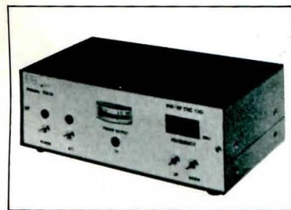
alimentación a 13,8 V, atenuación de espurias igual o mayor de 50 dB y una atenuación de armónicos que se cifra en 60 dB como mínimo en todas las bandas de radioaficionado y de 50 dB
