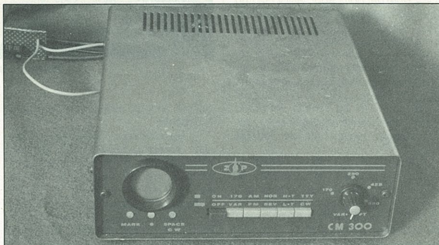
El modulador/demodulador de RTTY CM 300.
