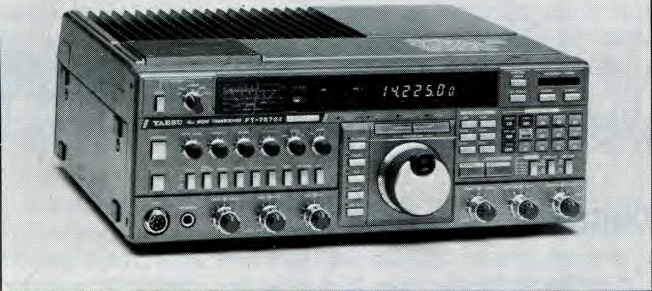
El Yaesu 767GX permite que el usuario pueda ajustar el compresor de audio incorporado siguiendo un método que se sirve del propio S-meter del equipo. (Foto cortesía de Yaesu).
