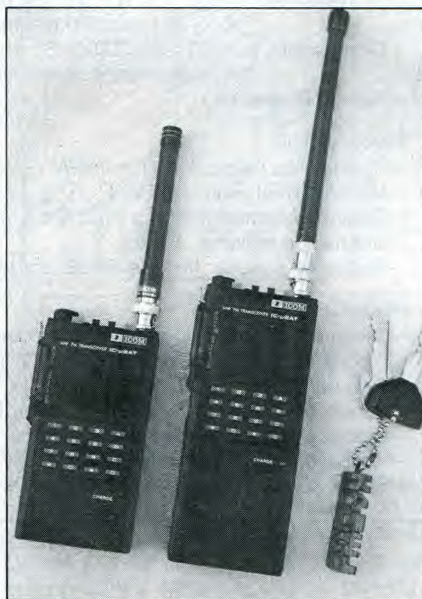
Figura 1. Las dos versiones del portátil FM ICOM IC- \mu 2AT descritas en el texto. A la izquierda la versión miniaturizada con su antena «miniporra» y batería opcional BP-21. A la derecha la versión normal, como viene de fábrica, con batería BP-22 y «porra» opcional de tamaño grande.
