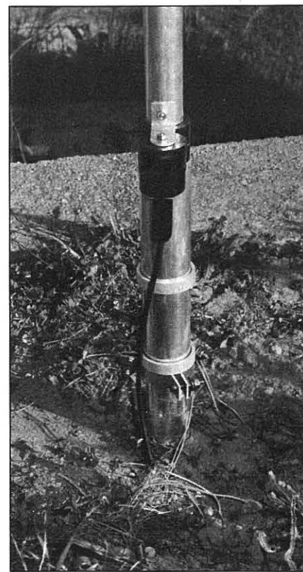
En esta instalación la base de la AP8 se montó sobre el extremo de una sección de 1,22 m de tubo de aluminio de 4,445 cm de diámetro previamente clavado en el suelo.
