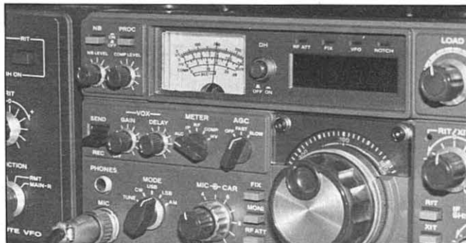
En nuestros equipos como el de la foto, la máxima información de cómo andan las cosas la tenemos por el medidor. Conmutándolo, conocemos la tensión de ALC, tensión de placa, salida de RF, nivel de compresión y alta tensión de paso final.
