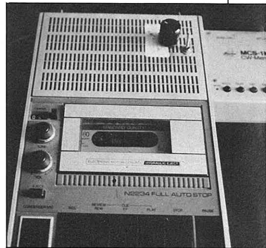
Magnetofón modificado con potenciómetro y conmutador para pasar de alta a baja velocidad.
