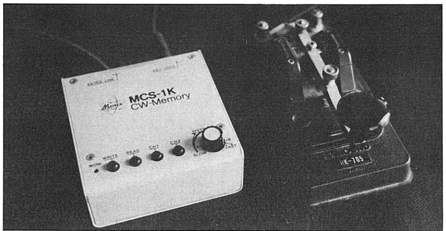
Memoria electrónica capaz de grabar CW a baja velocidad y reproducirla a 1000 l.p.m.
