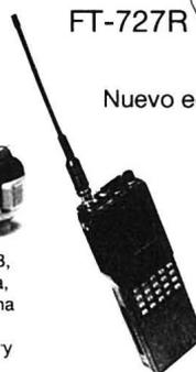
Tranceptor portátil Dual Banda VHF-UHF 5WTS RF, 10 memorias, semi duplex, teclado con 40 comandos. Vox control. Scanner. Voltímetro estado batería digital. Modulación F3. Alimentación 6-15 VDC. Canal de prioridad. Display de cristal líquido.
