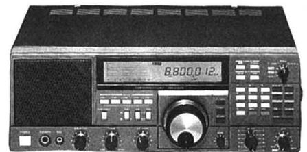
Receptor banda corrida de 0 a 30 MHz con conversor para recibir de 134 a 174 MHz.
