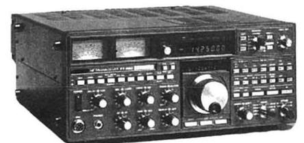
Equipo decamétrico banda continua, 13,5 V, 200 W.
