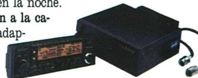
Yaesu, preside el diseño del FT-4700RH. El teclado frontal (diez teclas) incluye una verificación audible «do-re-mi» y todos los mandos llevan iluminación indirecta para la operatividad nocturna. El margen de recepción abarca de 140 a 174 MHz. Memoria de nueve canales en cada banda. Selección de potencia de emisión «Hi-Lo» (5W en Lo). Tecla de inversión de frecuencias de repetidor (±). Módulo CTCSS opcional. Y micrófono con DTMF de 16 botones.
