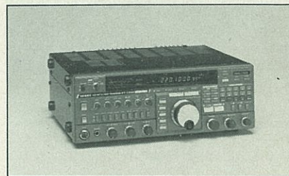
El FT-736R de Yaesu integra en una sola unidad los modos B, J y L del OSCAR 13. Añádele un simple preamplificador de GaAsFET para 2 m y 70 cm, antenas, y ¡disfrútalo!
