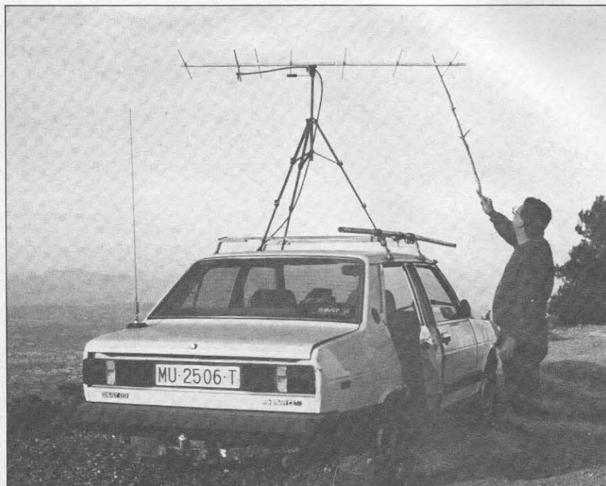
Ingenioso y práctico sistema que utiliza Ireño, EB5FJT, para instalar la antena de 144 MHz (2 metros) cuando trabaja en móvil y puntos altos. El modo de rotación podría denominarse «a palo seco» Hi.
