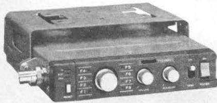
Programación a diodos 8 canales, 50 W. 134 a 174 MHz.
