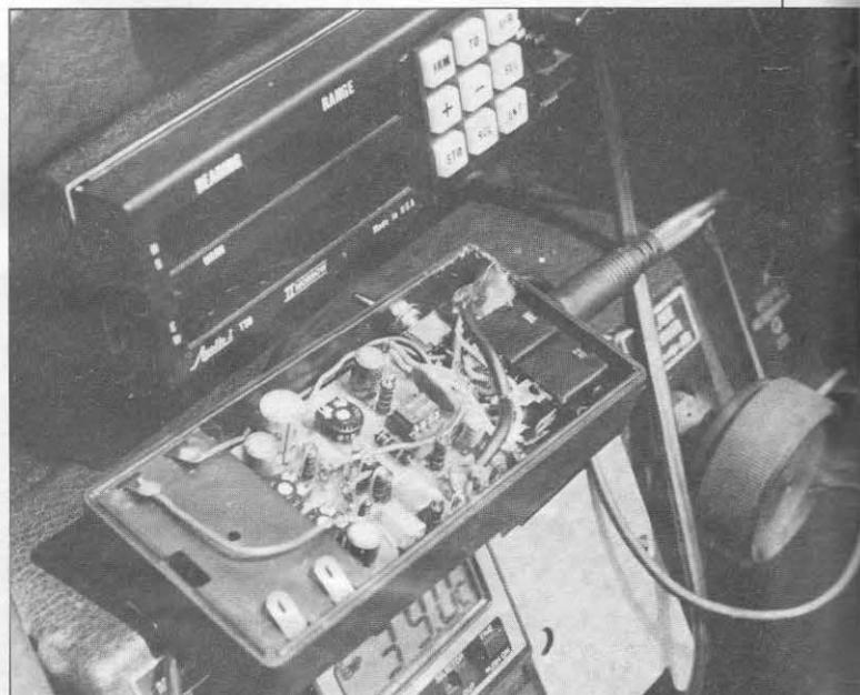
El interfono abierto mostrando su interior. En la parte superior puede verse el sistema de orientación por radio «Loran» (Long Range Navigation).
