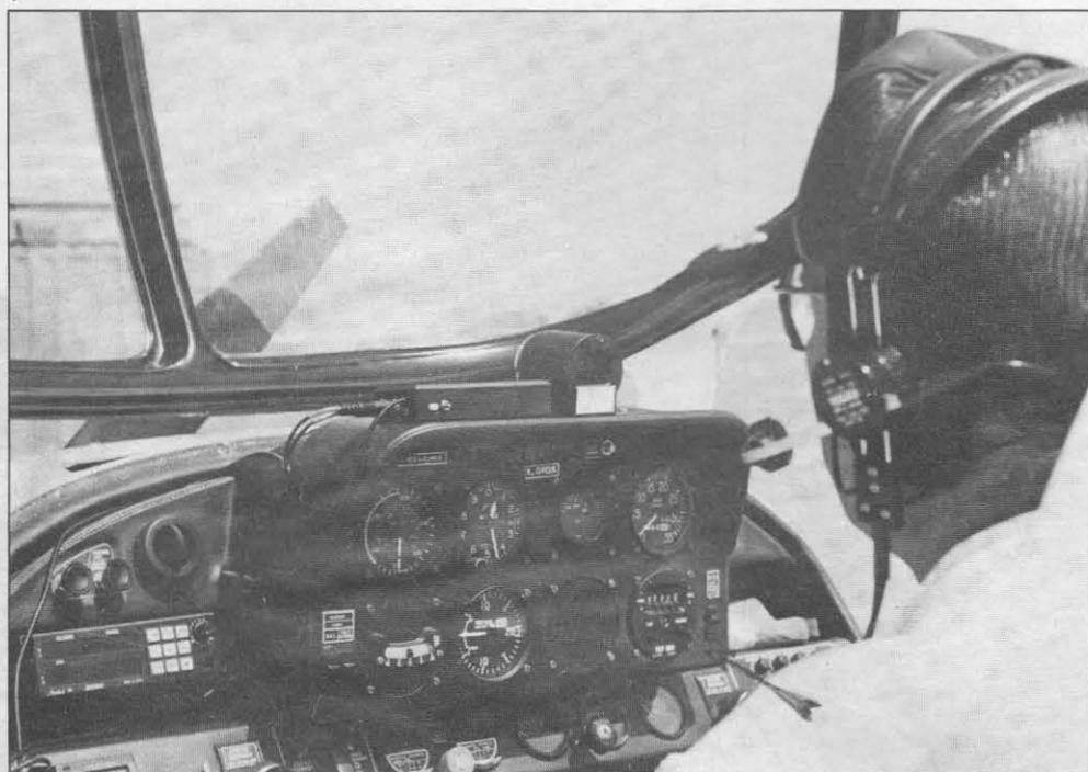
¡Qué interesante es el cuadro de mandos de un avión! Señalado con una flecha, el equipo de radio de VHF. Sobre el panel de instrumentos y a la izquierda de la brújula de agua, el interfono ya instalado pegado con «Velcro» autoadhesivo.
