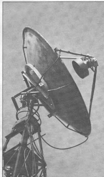
Detalle del «feed horn», detrás previo y convertidor.
