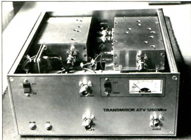
Transmisor de TVA-AM. Vista de los módulos que lo componen.
