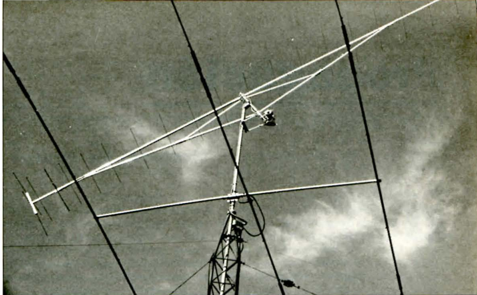
Antena Yagi para 144 MHz de EA3MD con rotor de elevación.
