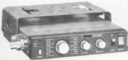
Programación a diodos 8 canales,
