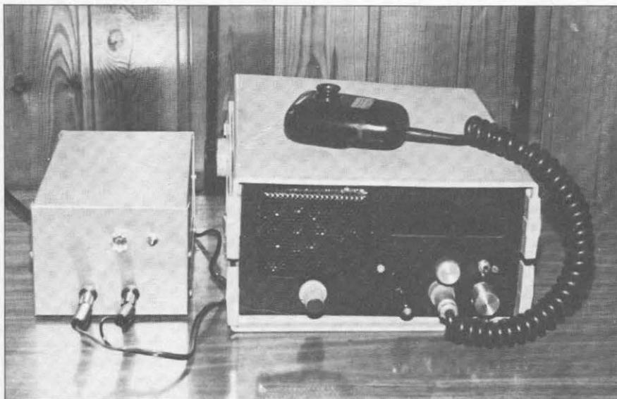
Transceptor de FM de 2 metros de construcción casera con la fuente de alimentación.
