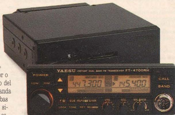
incorporado, 9 memorias por banda. Recepción ampliada. Inversión desplazamiento frecuencia repetidores. Conmutador potencia Hi-Lo. Prolongador para ubicación remota. Dial LCD de gran luminosidad. Mandos con iluminación indirecta. Elección de micrófono opcional. Y sigue...
