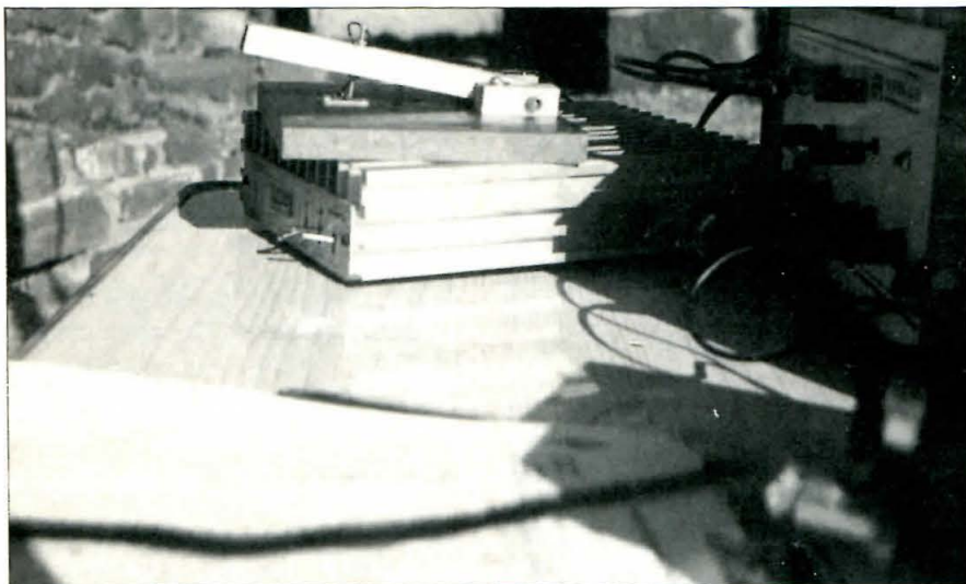
Casero e improvisado manipulador fabricado sobre la marcha por EA3EZG para obtener el 10 % de bonificación en el concurso Maratón.
