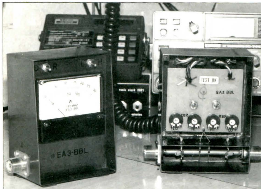
Figura 4. Vista anterior y posterior del instrumento. Los interruptores de cambio de escala y de potencia directa/reflejada se montan en el panel delantero de la caja y se unen al circuito impreso con unos cablecillos.
