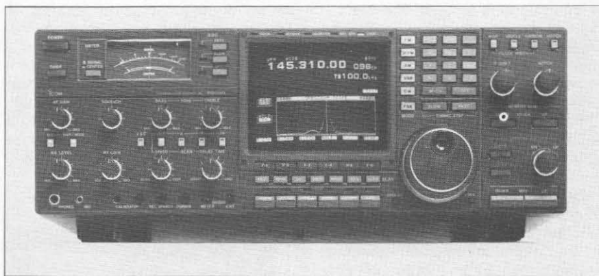
Aspecto del nuevo receptor toda banda, toda modalidad, Icom R-9000.
