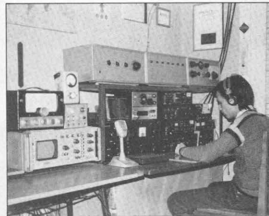
LU6DW, una estación de construcción propia (salvo el osciloscopio y el vatímetro) que participó en el concurso de CW.
