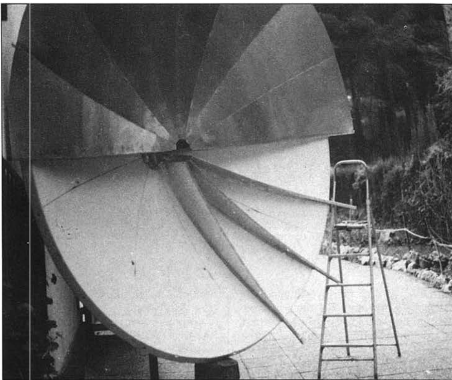
En plena transformación de relación f/d . Obsérvese la diferencia de ambas curvaturas.
