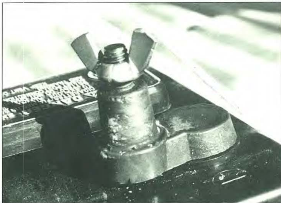
Las facilidades de conexión de los bornes de determinadas baterías sugieren infinidad de ideas sobre la instalación del equipo portable o móvil.
