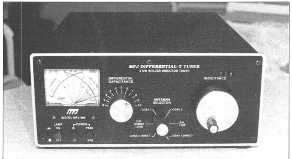
Los mandos del panel frontal se hallan agrupados con toda lógica para facilitar su manejo. Un contador de revoluciones permite registrar los valores de inductancia.
