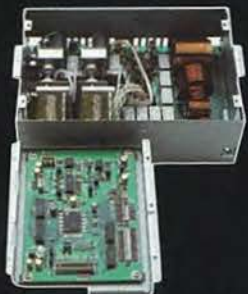
Circuito Acopl. Antena automático
