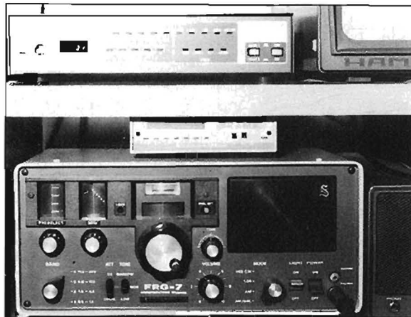
De arriba a abajo: Packkit 232, KAM y receptor HF.
