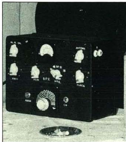
Transmisor de HF «Gehisa», de 50 W, construido por EA4DY y utilizado en Somosierra para la preparación de citas en VHF.
