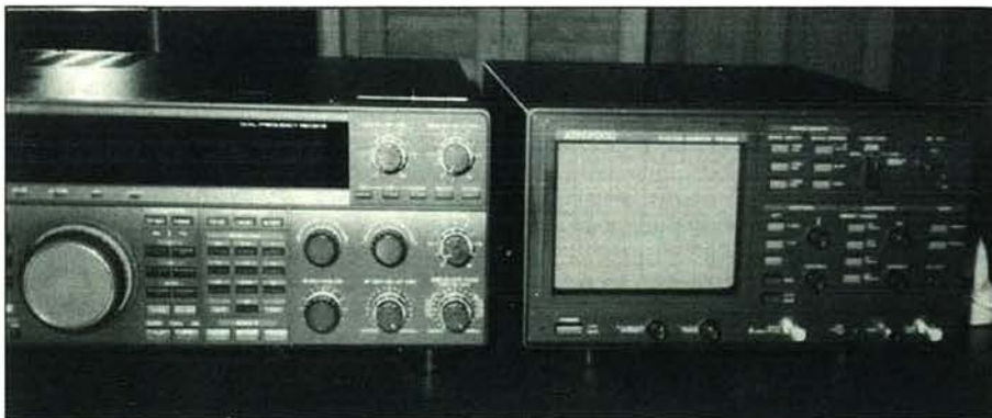
El monitor SM-230 complementa perfectamente la apariencia del TS-950S. Lleva una amplia pantalla de 6" y sirve para varios cometidos, como se explica en el texto.
