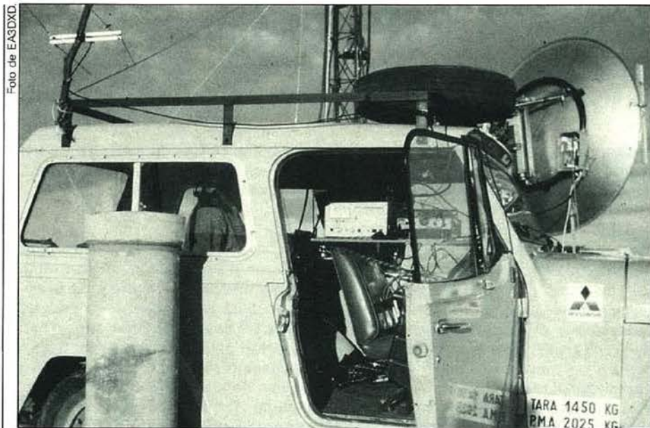
Vehículo todoterreno de EA3DJL convertido en estación de 1296 MHz.
