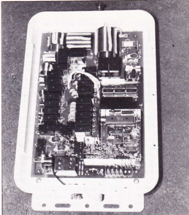
Al observar el interior del acoplador AT-300 se distingue un circuito impreso de 20x30 cm (aproximadamente). Para obtener la fotografía se retiraron temporalmente varios blindajes internos. Repárese en que las ocho bobinas que contiene se hallan consecutivamente alineadas en ángulo recto para evitar interacciones. No se distingue bien, pero existe un pulsador de prueba y un LED de «sintonía», de manera que se puede llevar a cabo una secuencia de sintonía de prueba junto al propio acoplador con fines de ajuste o ensayo.
