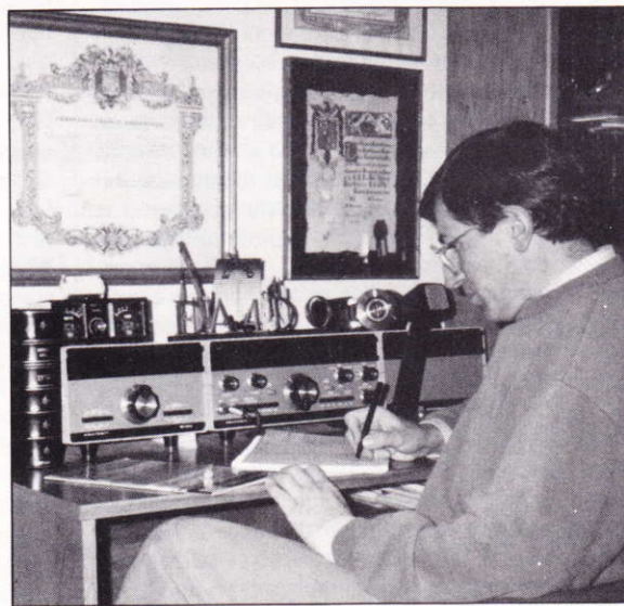
Particularmente me resulta divertido utilizar el viejo receptor de mi padre, Heathkit SB-104, en la posición de QRP, para trabajar en SSB con un vatio, y con condiciones de excelente propagación, estaciones de Japón, la Costa Oeste de EE.UU., China, Hawai y otros llamativos DX.
