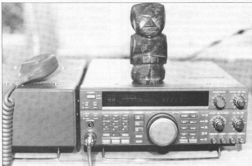
Transceptor TS-450S con su fuente de alimentación en el momento de saludar a su operador con un «HELLO» inicial en el visualizador, difícilmente visible en la reproducción gráfica.
