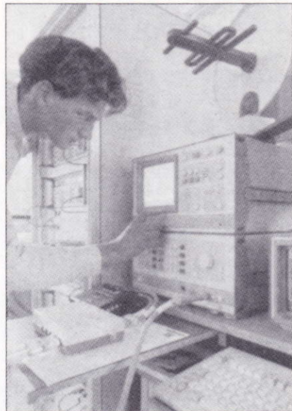
Figura 4. Pruebas de laboratorio de los receptores panorámicos (con analizador de espectro) de las estaciones de control alemanas.
