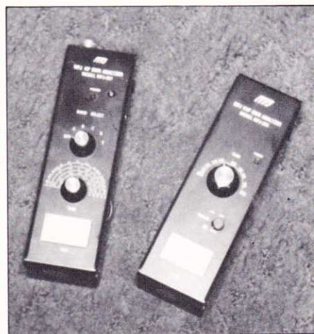
Ambas unidades se parecen, excepto por el conmutador de bandas del MFJ-207, para cobertura entre 160 y 10 metros.
