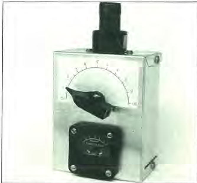
Foto 3. El ondámetro de absorción es un sencillo instrumento de medida con múltiples aplicaciones y que no debe de echar en falta nadie que experimente en RF.
