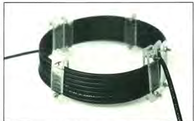
Foto 1. Aunque puede haber muchos métodos, con doce plaquetas de plástico agrupadas de dos en dos y sujetas con un par de tornillos cada una, se puede dar forma a la bobina de desintonía.
