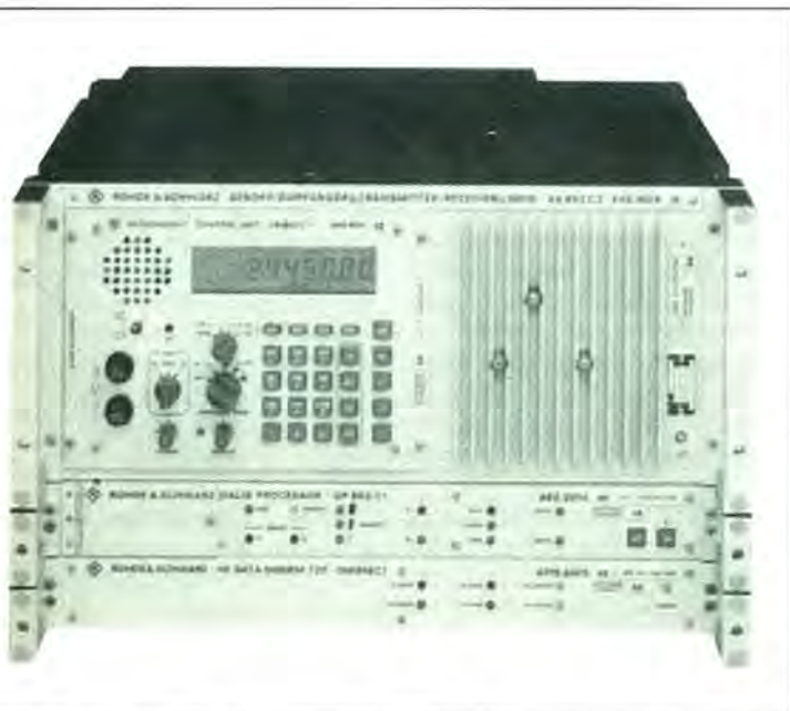
Figura 3. El radioprocador ALIS con el transmisor/receptor de 150 W y el modem para HF.
