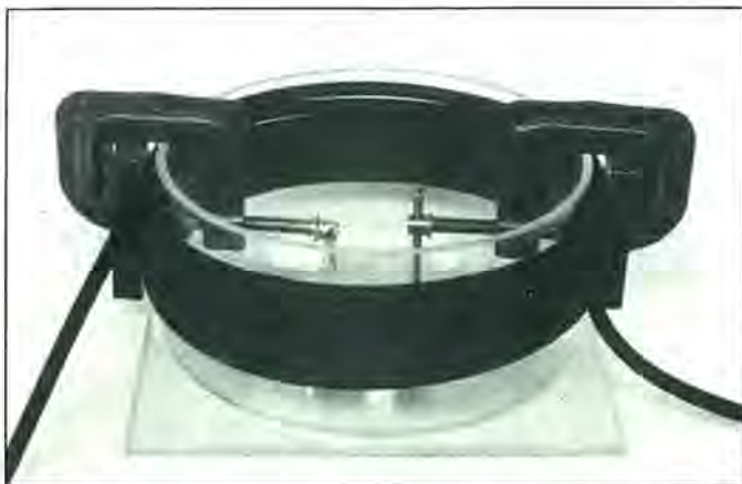
Foto 2. El autor ha usado este artificio para hacer los ajustes de la bobina de desintonía. Cualquier sistema que permita desplazar las espiras en un sentido u otro sería válido.
