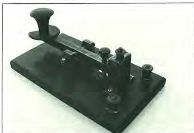
Foto 6. G4ZPY me remitió esta imagen del manipulador Creed utilizado por el Post Office británico allá por 1915. Constituye una pieza notable para el estudio de la tradición británica. Obsérvese la robusta palanca y el bloque del yugo descentrado, junto con la empuñadura del tipo «sombrero de copa». Los contactos se hallan en el interior del soporte prismático posterior con su separación regulada por el tornillo que asoma sobre el propio soporte. ¡Fascinante!
