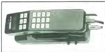
dentamente destinado al servicio móvil (por su forma), este «radioteléfono» se alimenta a 12-15 Vcc y consume unos 2 A tanto en AM como en FM según su fabricante (250 mA sin señal). Receptor superheterodino de doble conversión con FI de 10,695 MHz y 455 kHz y relación señal/ruido con 1 mV de entrada: 40 dB.
