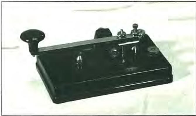
Foto 12. Interesante combinación de sencillez y elegancia la que ofrece este manipulador japonés fabricado por Sato Company. Sus pequeños tornillos reguladores llevan un hilo de rosca muy fino y los tornillos para el ajuste del fiel se aseguran con tuercas dobles en el yugo. Pertenece a WBØAUQ, quien nada nos ha dicho acerca de su tacto pero, a la vista de la artesanía, se diría que manejarlo debe ser una delicia.
