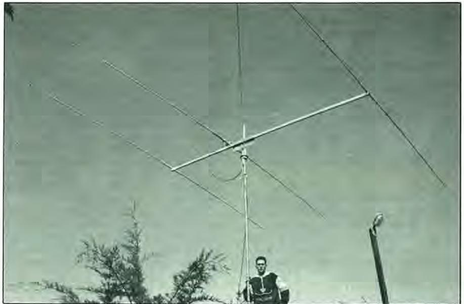
Miniantena de tres elementos para 21 MHz de construcción casera realizada por EC3CIL y EA3FQV.
