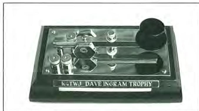
Foto 7. ¡Me llega al corazón este suntuoso manipulador vertical fabricado por G4ZPY! ¡Es absolutamente espectacular! Lanza destellos por cualquier lado que se le mire y ofrece una profunda brillantez que corta el aliento. Los contactos van montados sobre aislantes de teflón y la regulación es excepcionalmente precisa. Usar este manipulador es como conducir un Rolls Royce. (Fotografía de K4TWJ).
