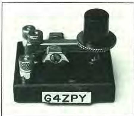
fía que se muestra se realizó a través de una lente de aumento para que se apreciaran bien todos los detalles. La parte metálica es de latón pulimentado hasta el extremo de obtener el brillo del oro y va montada sobre una base que tiene el aspecto de madera de nogal. Tensión de muelle y separación de contactos ajustables. ¡Una maravilla!
