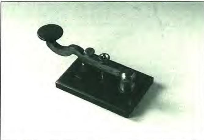
Foto 3. Manipulador con joroba de camello de fabricación alemana (Zimmerman Leipzig) propio de finales del siglo XIX. Obsérvese el soporte posterior y el diseño tan sencillo y tan eficaz a la vez. La tuerca cónica de regulación es un signo tradicional que ha prevalecido en los manipuladores alemanes. (Foto cortesía de K1BH).
