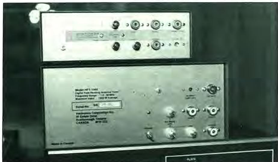
Vista del panel posterior de ambos acopladores. Profusión de conectores para línea coaxial, para línea alámbrica unifilar y para línea paralela (simétrica).
