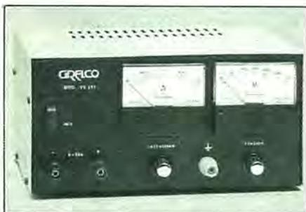
gativo y así reducir el nivel de ruido. Dos instrumentos de medida en cada fuente. El modelo V241 con una intensidad máxima en toda la gama de tensión de 1,5 A y el modelo VE243 con intensidad máxima de 3 A. Ondulación residual de 1 mVef, con tolerancias del 0,1 % típica sobre la línea de regulación de carga y de 0,05 % sobre línea de regulación de red.
