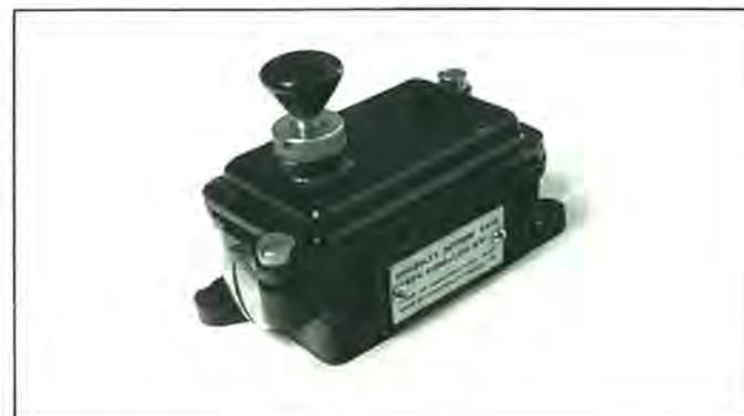
Foto 8. *Sparton de Canada Ltd.* fabricó estos manipuladores herméticos durante el año 1943. Hoy constituyen una deliciosa originalidad para cualquier coleccionista. Todos los ajustes son interiores, con lo que resulta un manipulador ideal para operar en la playa o desde el móvil marítimo. Es una delicia utilizar manipuladores miniaturizados como éste, pero su hallazgo constituye toda una proeza. (Pertenece a VE7FOU, autor de la fotografía).
