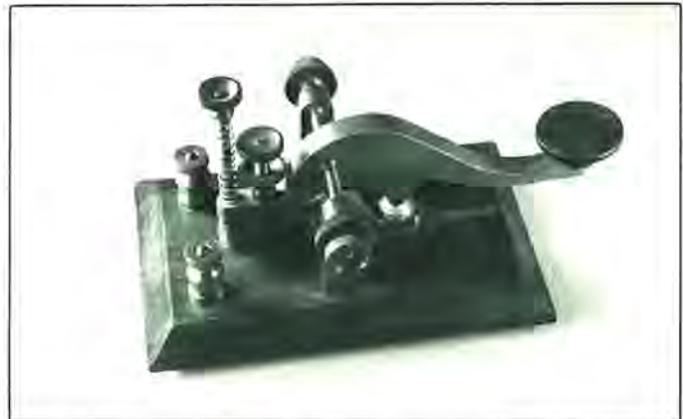
Foto 1. Este original Chubbock pertenece a la mitad del siglo XIX (sobre 1850) y tiene un diseño muy curioso. Notar que el fiel pivotado de la palanca permite que ésta se asiente casi llana sobre la base y que sea el largo tornillo posterior el que regule la tensión. El contacto inferior también se halla aislado de la base de latón. (Manipulador propiedad de K1BH, autor de la fotografía).
