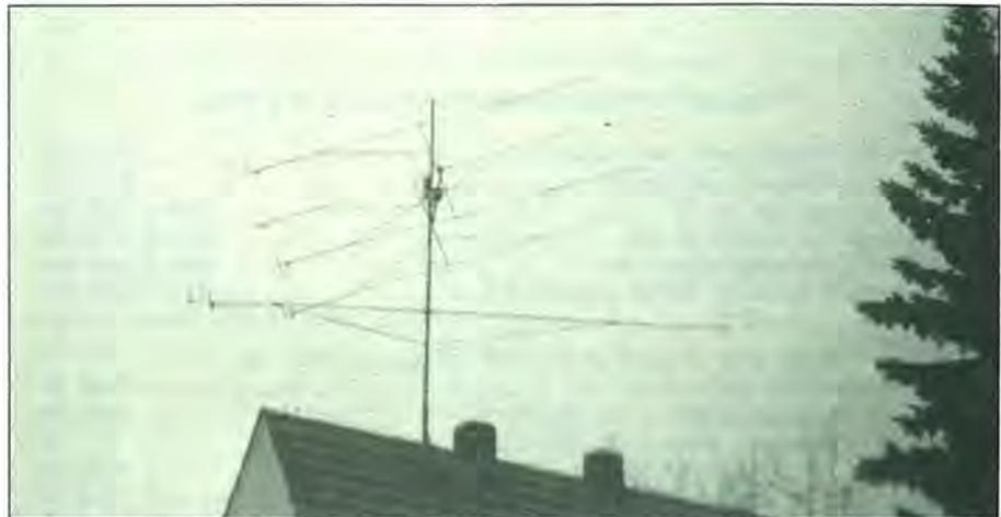
DL9NDD, ejemplo de pequeño, pero eficaz sistema (a juzgar por su señal) para 432 MHz/EME. Cuatro antenas Yagi DJ9BV.
