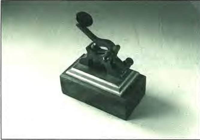
Foto 2. Merece la mayor atención este pequeño y raro manipulador tipo «joroba de camello». ¡Va montado con un ángulo extraño y lleva un muelle muy robusto, cual si procediera de un revólver Colt 45! Los operadores que lo utilizaron debían ser verdaderos atletas. (Propiedad de K1BH, autor de la fotografía).
