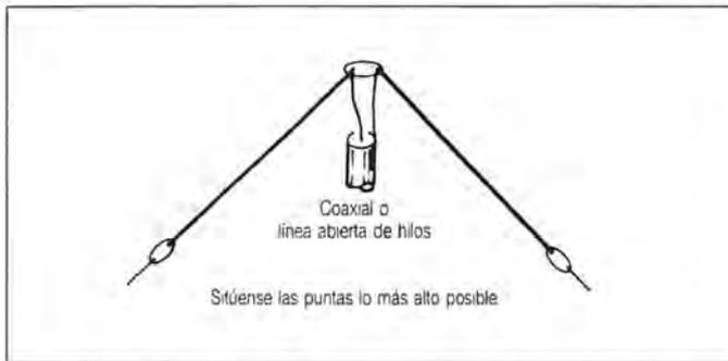
Figura 2. La V invertida es una antena muy popular. Puede tener un largo de media onda. El dipolo McCoy («háganse tan largos como sea posible») requiere una línea de hilos paralelos y un adaptador de impedancias. El centro de la antena ha de estar tan elevado como sea posible, lo mismo para las puntas.
