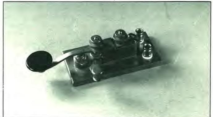
Foto 5. Esta es otra pieza de colección que procede de mediados del siglo XIX. Es un manipulador *Stiener* fabricado por *Western Union Telco*. La palanca se sujeta únicamente con la tuerca posterior. La tuerca anterior regula la tensión mediante la aplicación de presión hacia abajo en la parte posterior de la palanca. ¡Buen aspecto, eh! (Manipulador propiedad de K1BH, autor de la fotografía).
