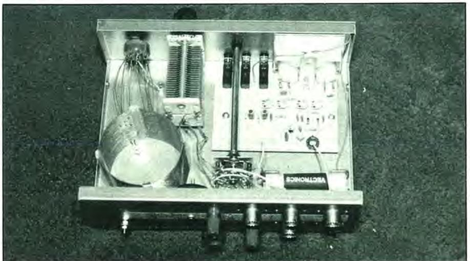
Vista del interior del modelo VC-300 DLP. A la izquierda, sobresale el gran tamaño de la bobina de la red en T; el resistor antiinductivo con el nombre Vectronics que se halla a la derecha constituye la antena o carga artificial.
