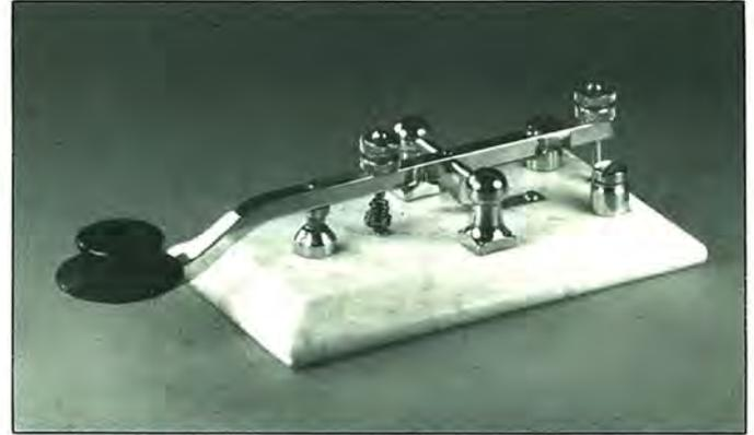
Foto 4. ¿Alguien puede identificar a este elegante manipulador sin marca alguna? En caso afirmativo su propietario, K1BH, agradecerá que se le comunique. Resulta notable el abundante cromado de las piezas superiores, de los pedestales redondos que sujetan la barra del fiel y las tuercas dobles en los tornillos de regulación. La base es de exquisito mármol y su apariencia general es impresionante.
