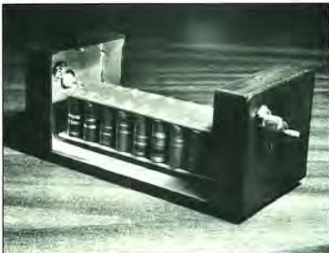
Vista interior de la antena artificial. Repárese en la prácticamente nula longitud de los rabillos de los resistores y en el conector BNC. En la parte posterior aparecen los terminales para la conexión de la sonda del osciloscopio.
