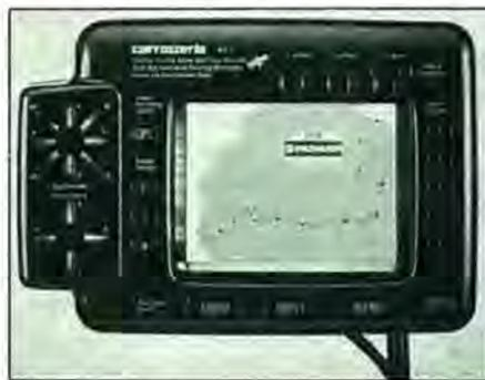
El sistema técnico, denominado AVIC-1, está compuesto de cuatro elementos tales como: una antena para captación de señales de satélite, un receptor que decodifica las señales para el análisis de los datos, un procesador gráfico que permite la confección de mapas y un controlador visual que incluye un panel de control operativo que refleja, en una pantalla de cristal líquido de 10 cm, la información que proviene del procesador gráfico y de los mapas e imágenes procedentes del productor CD-ROM.
