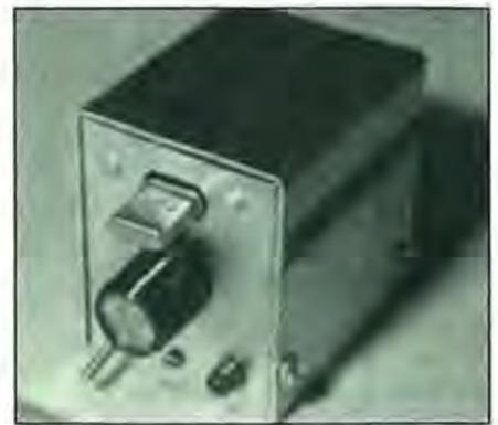
ofrece el kit para el montaje de este pequeño transmisor QRP CW conocido como «Oner» y que se debe al diseño de DJ4SB. Sus medidas son de 47 x 47 x 38 mm y proporciona una potencia de 1,2 W de RF en la banda de 40 metros. Con el receptor apropiado (un monobanda de 40 metros también disponible en kit) puede constituir toda una estación de radioaficionado de lo más económico... ¡siempre que el operador domine el Morse, claro está!
