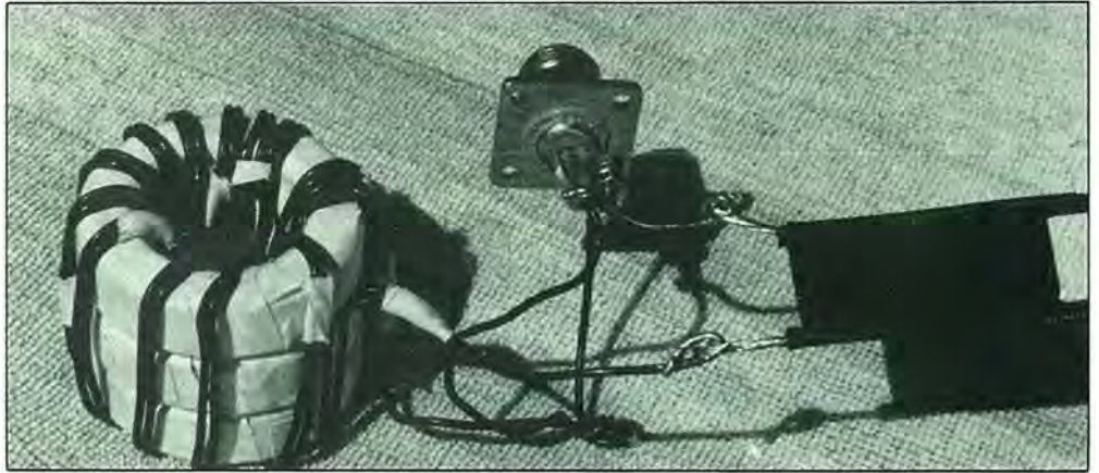
Construcción deliberadamente abierta para mostrar los devanados bifilares y las uniones al conector coaxial SO-239 y a la línea paralela. Este montaje funciona correctamente desde el punto de vista eléctrico, pero en la práctica es preciso montar el transformador y los conectores en el interior de una cajita estanco capaz de soportar la intemperie.
