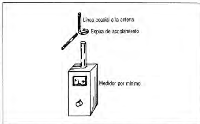
Figura 1. Acoplamiento del medidor por mínimo a una espira de línea coaxial. El simple deslizamiento de la bobina del medidor a lo largo de la línea no suele proporcionar un acoplamiento suficientemente fuerte. Como se describe en el texto, si se halla un «dip» dentro de las bandas de radioaficionado, convendrá alterar la longitud de la línea para trasladarlo fuera de la banda bajo medida.
