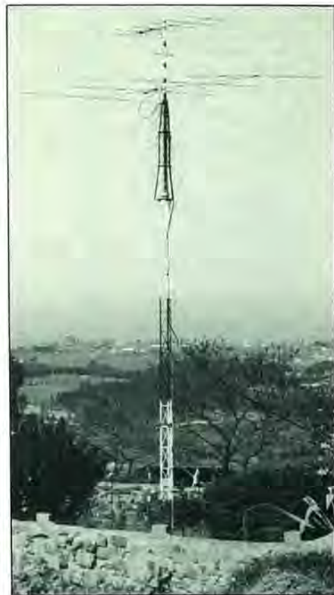
Paradisiaco QTH de José M.ª, EA1EBJ, y en primer plano sus Yagi de 4 elementos para 50 MHz y 6 elementos para 144 MHz de construcción propia.
