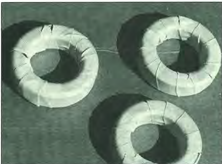
En la primera parte de este artículo se mostró el kit preparado por la firma The Wireman. Aquí aparecen los tres núcleos toroidales de polvo de hierro recubiertos con la cinta aislante 3M.
