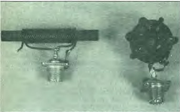
Foto A. Las dos versiones prácticas del unun modelo Ruthroff de relación 4:1 (50:12,5 \Omega ); con varilla y devanado alámbrico a la izquierda y con toroide y cable coaxial a la derecha.
