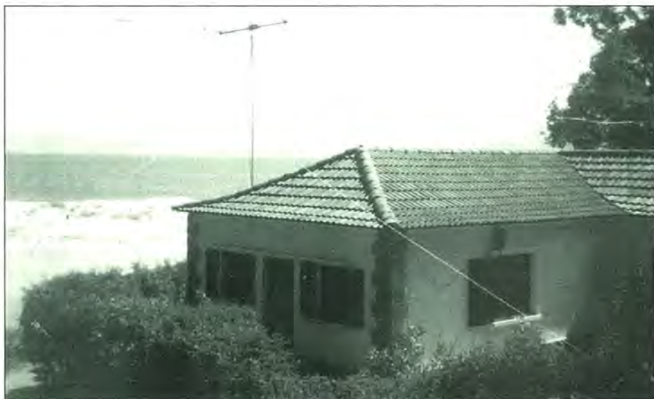
Una vista del chalet, a la izquierda la directiva de dos elementos, a la derecha el dipolo rígido de 10/40 metros y sobre la ventana el acoplador automático.
