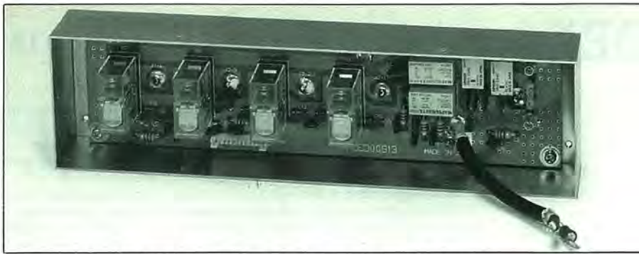
Vista interior de la red conmutadora de antenas.
