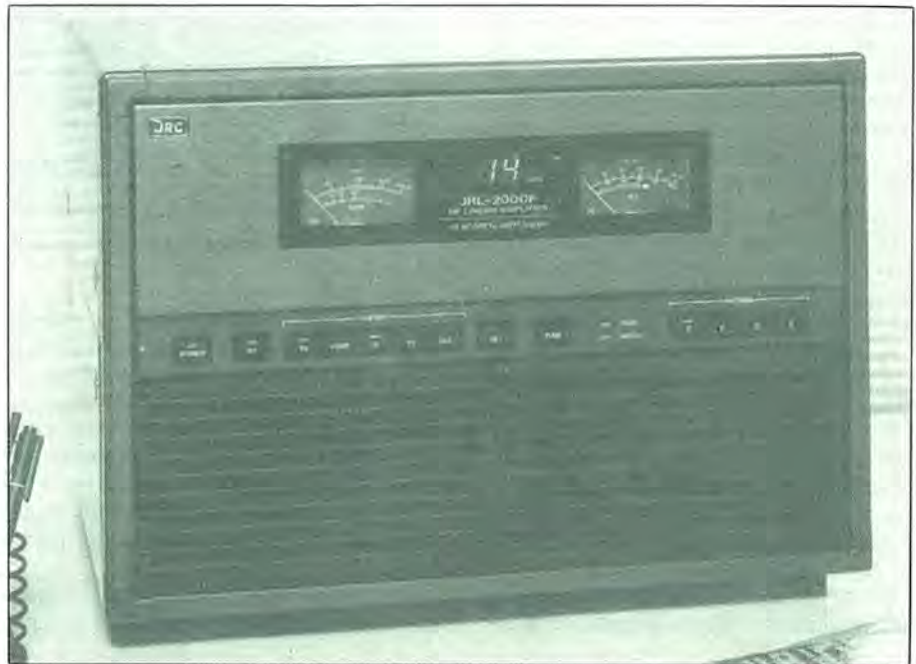
Vista frontal del amplificador lineal JRL-2000F. Es una unidad que se puede instalar en cualquier rincón de la estación para manejarla con el mando a distancia NCH-365.
