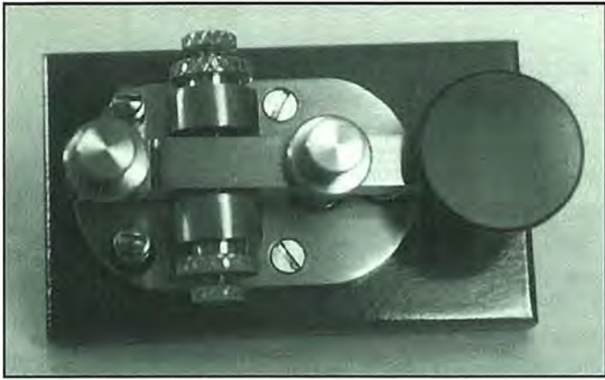
Foto 5. Vista superior del manipulador de W8WVM en la que se distingue la escasa distancia entre el brazo y los pivotes. Es una originalidad que me recuerda el típico manipulador Chubcock.
