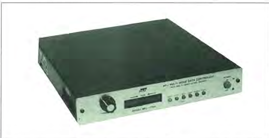
Con la incorporación del PACTOR y alta resolución en color para televisión de barrido lento (SSTV) el MFJ-1278B ofrece muy buenas prestaciones por un precio módico. (Foto cortesía de MFJ Enterprises Inc.).
