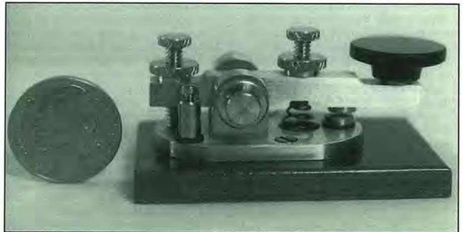
Foto 4. Vertical miniatura fabricada por W8WVM con piezas de desguace. Tiene una longitud que no llega a los seis centímetros y un mecanismo de latón asentado sobre una base de madera de cerezo.
