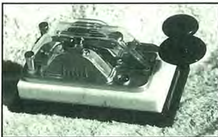
Foto 3. Vertical Hi-Mound HK-702 . Bello ejemplar con mecanismo cromado y plateado montado sobre una base de mármol blanca. Lleva cubierta guardapolvo de plástico de la que sobresale la empuñadura. Su importador en EEUU es K8XF, Mike, quien también se ha convertido en coleccionista y usuario de manipuladores especiales en la banda de 30 metros.
