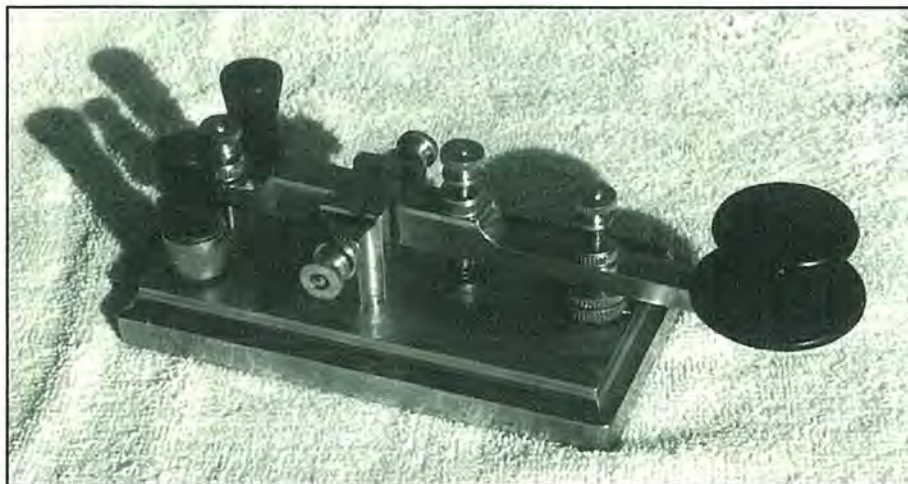
Foto 13. Esta construcción artesana de N1KPR es prácticamente igual a un Steiner de bronce. Sólo en la fotografía en color se aprecia toda la belleza de este manipulador.
