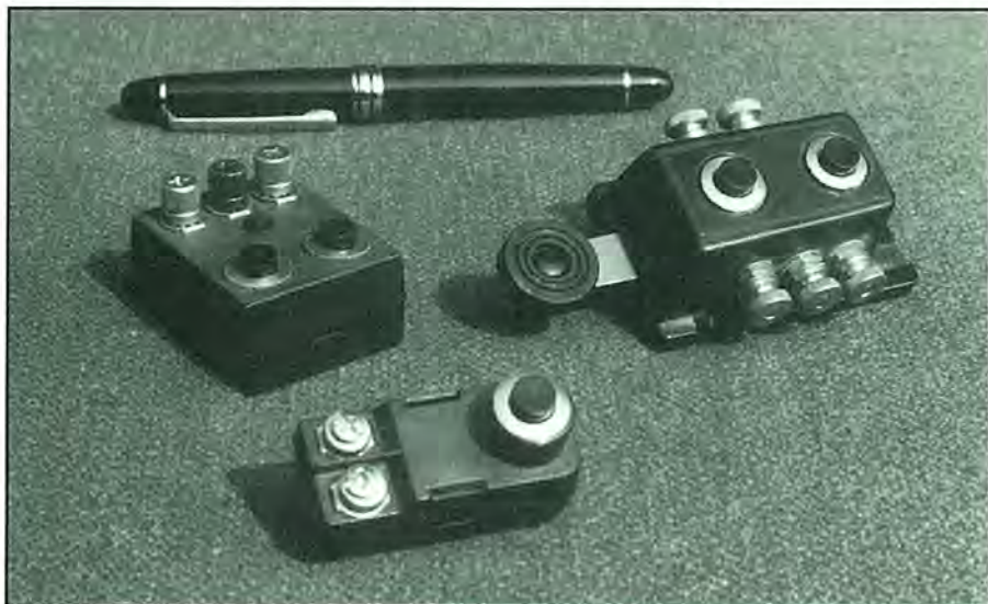
Foto 11. Tres modelos de manipulador de construcción doméstica montados por N1KPR partiendo de cajitas de balun de TV (abundantes en las tiendas del ramo).
