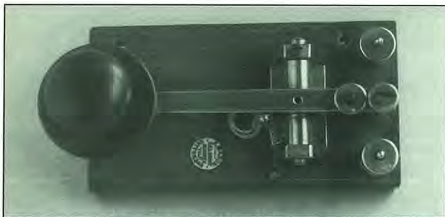
Foto 15. Vista superior del manipulador de G7APJ estilo 1930. La barra de equilibrio pivota se mantiene en posición mediante un juego de tornillos fijadores con tornillitos de retención en la cabeza.
