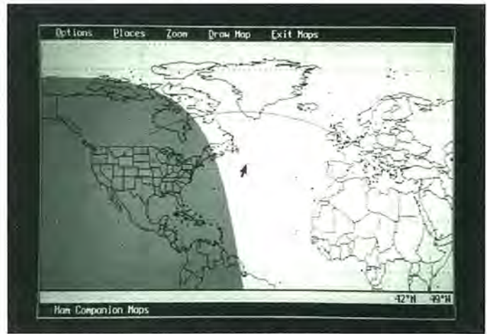
Figura 4. Pantalla obtenida con el Ham Companion en su faceta geográfica con zonas diurnas y nocturnas. Este programa contiene una descomunal carga de información destinada a toda clase de radioaficionado.
