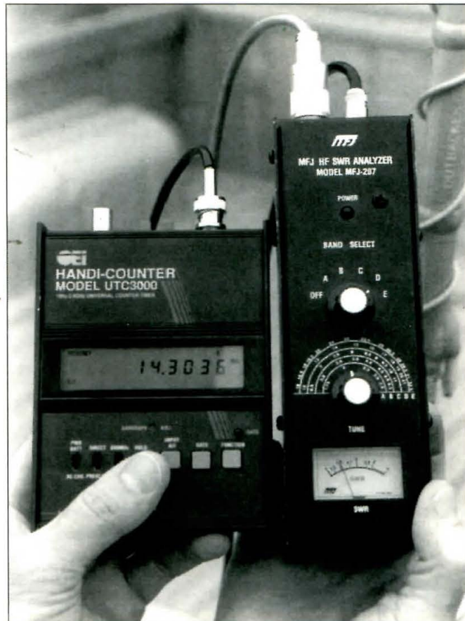
Figura 1. El analizador de ROE MFJ emite una señal cuya frecuencia mide con precisión el frecuencímetro Optoelectronics.
