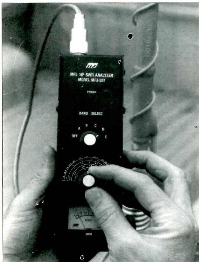
Figura 2. Mediante el barrido de frecuencia del OFV del MFJ se comprueba exactamente la frecuencia real de resonancia de la antena.
