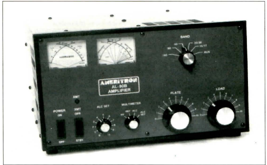
Aspecto del AL-80B. Obsérvese la amplia carátula de los instrumentos de medida en la parte superior izquierda del aparato. Arriba, a la derecha, se halla el selector de bandas y, por debajo del mismo, los mandos de placa y carga.
