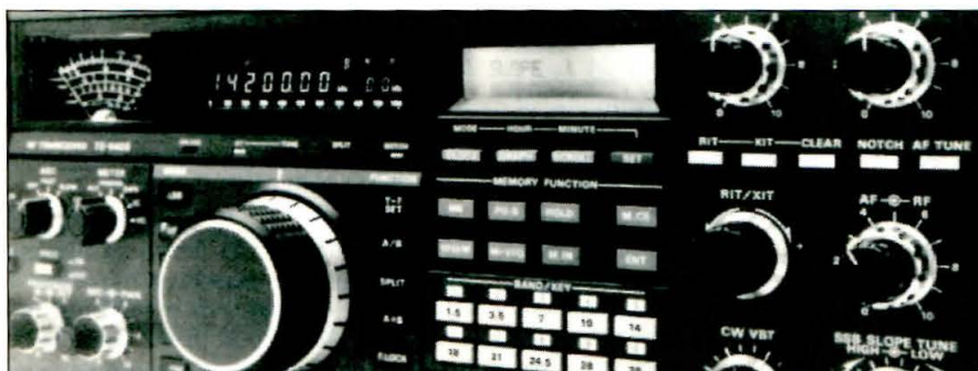
Figura 2. El filtro notch «elimina» una señal interferente como si de un «cuchillo» se tratara.
