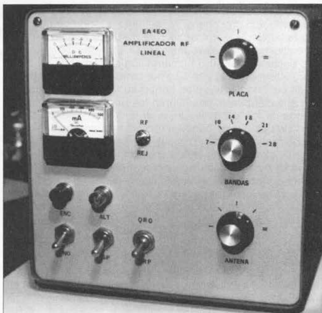
En el panel frontal se puede apreciar en la parte baja y casi centrado el conmutador de alta y baja potencia. En línea con éste y hacia arriba se encuentra un miniconmutador que hace que el miliamperímetro M1 pueda medir la RF de salida o la posible corriente de rejilla.
