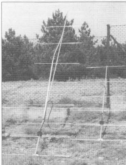
9EL2 y 6EL2 dispuestas para su instalación.
