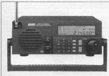
Drake es un receptor de onda corta controlado por microprocesador, de sintonía continua de 500 kHz a 30 MHz, de 87 a 108 MHz y de 118 a 137 MHz, AM y BLU de 0,5 a 30 MHz, AM de 118 a 137 MHz y FM de 87 a 108 MHz, doble conversión, con antena telescópica incorporada y alimentado a 7-10 Vcc con 1 A de consumo.
