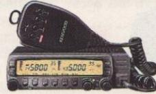
**TM-733 E** Transceptor móvil doble banda (144/430 MHz) - Potencia de salida de 50 W (VHF) y 35 W (UHF) - Recepción doble en la misma banda (VHF+VHF ó UHF+UHF) - Panel con frontal extraíble - Sistema de silenciamiento por 2 tonos (DTSS) con función buscapersonas - Sistema AIP
