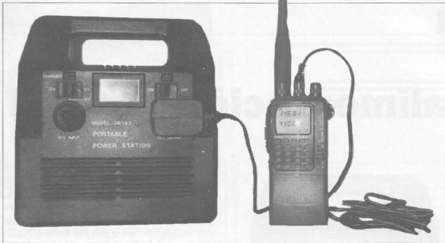
Esta imagen permite darse una idea del tamaño real de la Power Station que aquí está alimentando un portátil Icom IC-W21AT mediante el uso del accesorio CP-13, conector de encendedor de cigarrillos con filtro de ruido incorporado. No se trata de un gran armatoste, pero sí que realiza una gran tarea.
