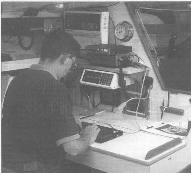
Figura 6. La instalación de uno de los veleros de 44 pies de la Academia. John Roe, N2HAQ, está al teclado. Esta instalación utilizaba el receptor de GPS Magellian incluido dentro de un TNC MFJ 1274, por lo que necesitaba solamente un conector de antena para el receptor GPS. Puesto que era una instalación provisional, la antena GPS estaba encintada simplemente al techo del barco y trabajaba bastante bien a través del casco de fibra.
