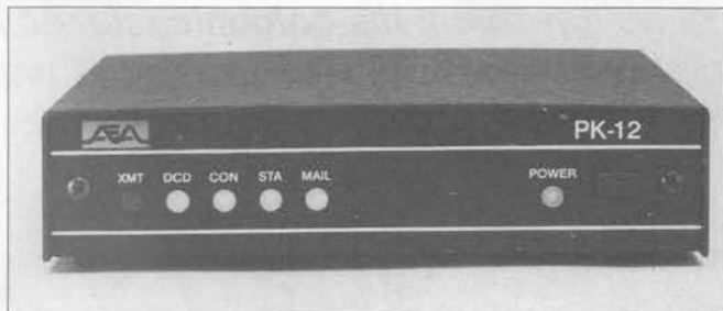
Fotografía C. El nuevo PK-12, capaz de trabajar a 1200 bps, incorpora el lector de GPS.
