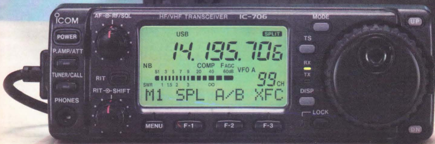
Cabezal frontal separable pudiendo de esta forma instalarse en cualquier lugar
