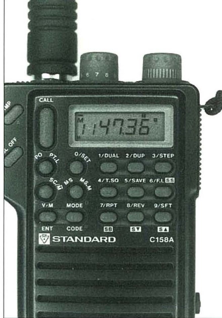
Detalle del teclado del C158A. El visualizador está indicando el canal de memoria 1, la frecuencia de separación de repetidor positiva (plus), el codificador tonal de transmisión activado (on) y la máxima potencia de salida (high).
