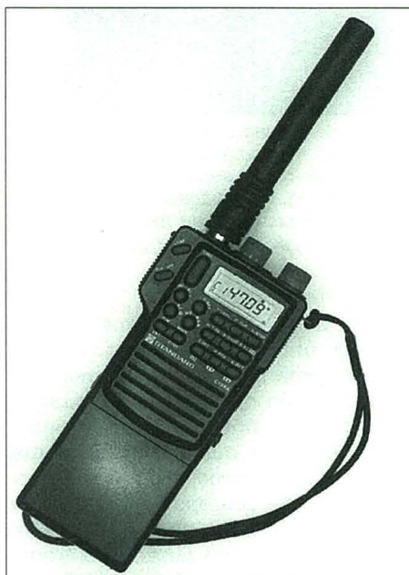
Vista del portátil Standard C158A con la batería de níquel-cadmio suministrada de 7,2 V y 700 mA. La conmutación «push-to-talk» (apretar para hablar) se halla en el saliente de la izquierda, con la tecla «function» justo encima de ella.
