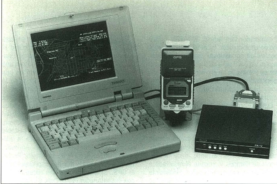
Foto 6. Sistema Global Positioning completo capaz de determinar la posición del lugar señalándola en un mapa adecuado e informar de ella a los demás automáticamente por la vía del radiopaquete.
