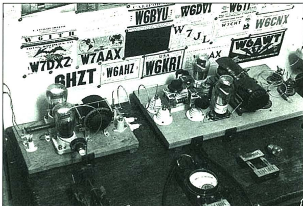
Equipo de 56 MHz de EA4AO, Jesús Martín de Córdoba, en 1936. El módulo de la derecha es el oscilador y el de la izquierda, el amplificador.
