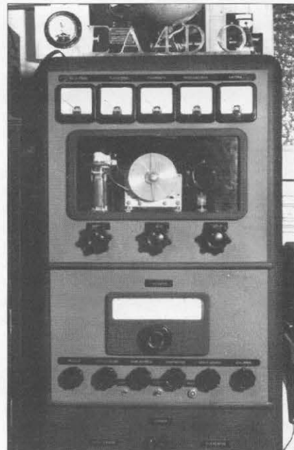
Transmisor «Pintora» de una «813» (arriba a la izquierda) construido por EA4DY en 1955.
