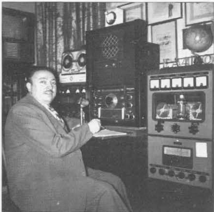
EA4DO operando su estación en 1957, compuesta por el «Tres de Bastos» a la izquierda, receptor National HRO-50R y «La Pintora», con una lámpara «813», tras la modificación de 4DY al introducir un nuevo condensador de placas para la sintonía de antena.
