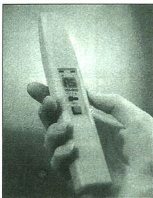
detectar fallos en bobinas, conectores, relés, solenoides y transformadores. Lleva un sensor del efecto Hall con una sensibilidad magnética de  $\pm 10$
