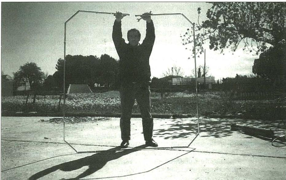
Foto 2. La dimensión de 1,90 m de sus lados permite su manejo por una sola persona.
