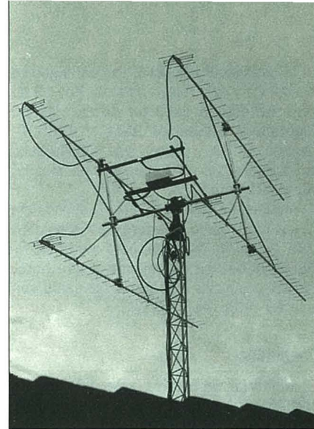
Antenas para rebote lunar (432 MHz) de PY5ZBU, cuatro Yagi de 26 elementos.
