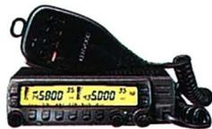
**TM-733 E** Transceptor móvil doble banda (144/430 MHz) - Potencia de salida de 50 W (VHF) y 35 W (UHF) - Recepción doble en la misma banda (VHF+VHF ó UHF+UHF) - Panel con frontal extraíble - Sistema de silenciamiento por 2 tonos (DTSS) con función buscaperonas - Sistema AIP
