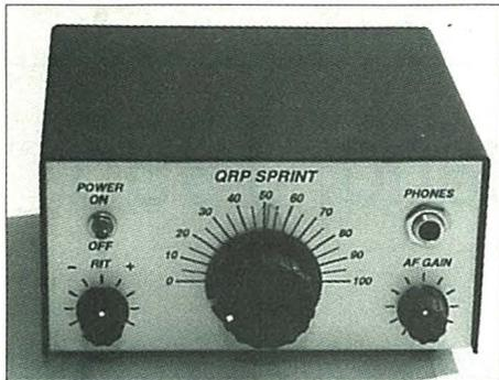
Foto 4. Aunque lamentablemente OHR ya lo ha descatalogado, esta es su versión del transceptor optimizado para 40 metros diseñado por Roy Lewallen, W7EL. 2 W para disfrutar de lo lindo.
