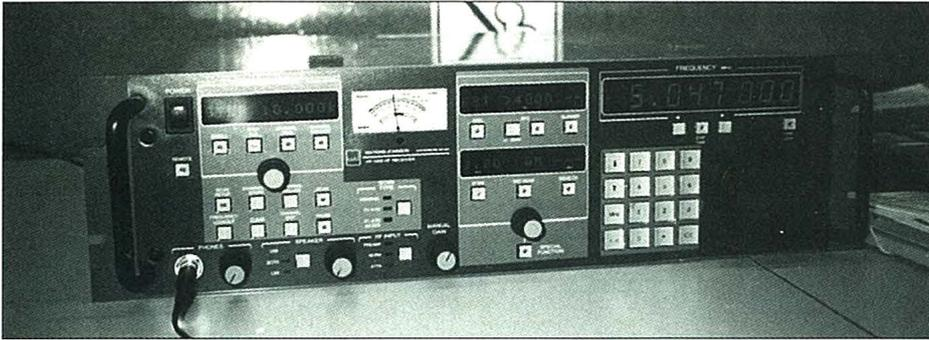
podido probar posiblemente el mejor receptor del mercado. Se trata de un equipo fabricado en EEUU: el *Watkins-Johnson HF-1000*. Un equipo que capta las frecuencias entre 5 y 30.000 kHz, con un paso de 1 kHz. Trabaja con la detección síncrona en AM, FM, CW, USB y LSB. Posee nada menos que 59 filtros para recibir todas las bandas y tiene hasta 100 canales memorizados. Se puede controlar a través de un interface con conexión RS-232 por control remoto.
