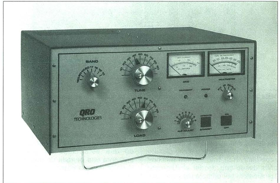
En el clásico panel frontal del «QRO HF-1000» destaca el mando de nivel del ALC.
