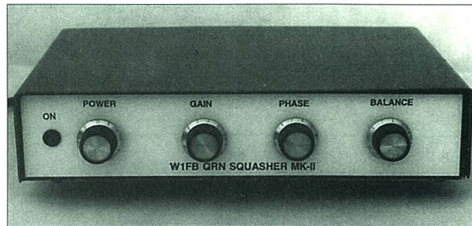
Vista frontal terminada. La carátula del panel se hizo con la ayuda de un ordenador, según se describe en el texto.
