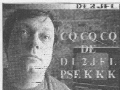
(DL2JFL). Mirar la cabecera, esa distorsión puede producirse por el excesivo nivel de salida del modem o del transceptor (muy a tener en cuenta).
