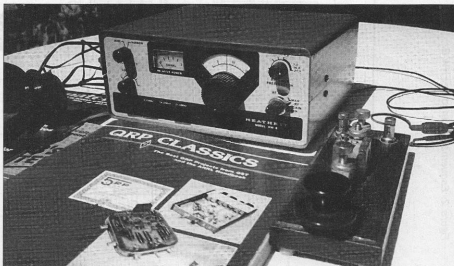
Foto 2. El Heathkit HW-8 acompañado de su inseparable manipulador Kent. Cuando la propagación no acompaña siempre se puede oír «QRP Classics» o CQ Radio Amateur.
