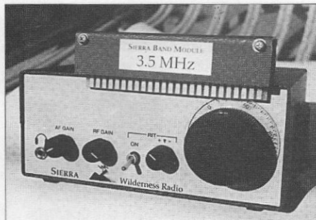
Foto 5. El transceptor Sierra, diseñado por Wayne Burdick, N6KR, un ejercicio de simplicidad y buenas prestaciones en un equipo QRP totalmente portable.
