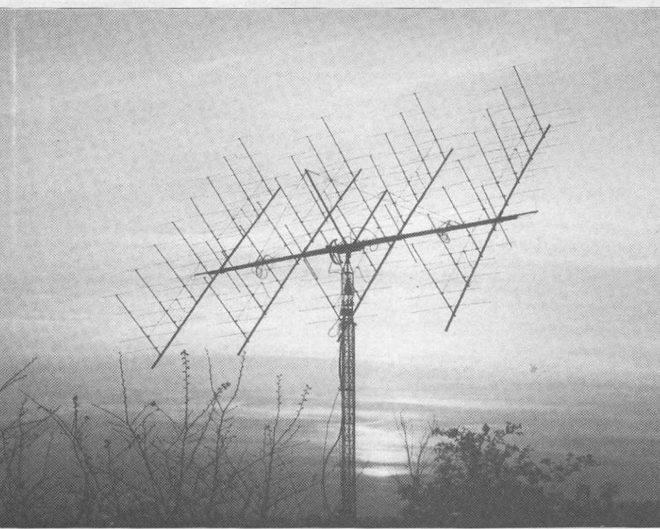
Antenas para rebote lunar de G8MBI. Formación colineal de 224 elementos.
