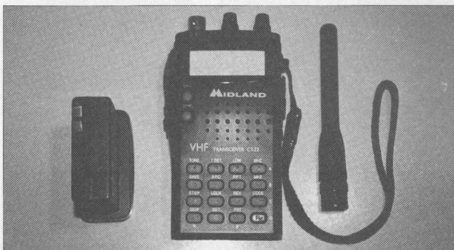
Obsérvese el perfil estrecho de la batería, que permite alojarse detrás del panel del teclado.
