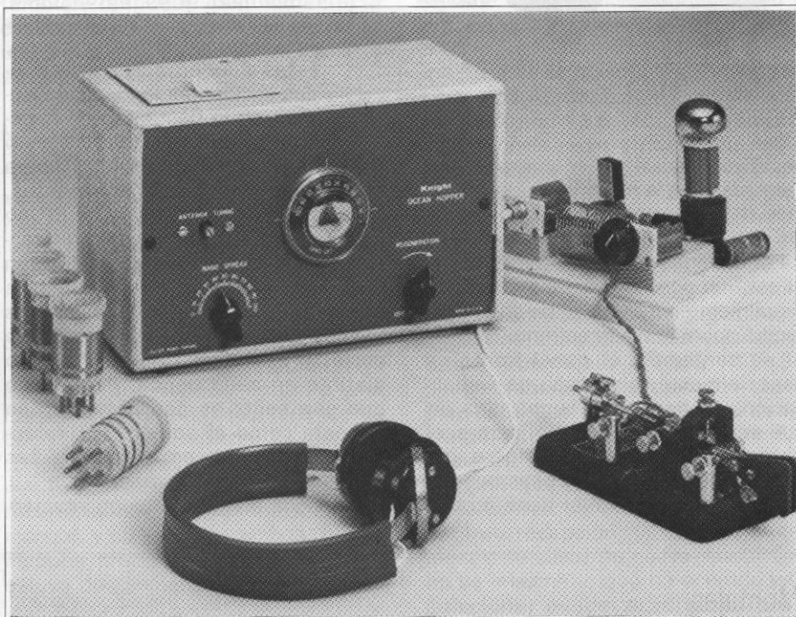
Figura 1. Un equipo «clásico» no necesita ser complicado o caro para ser divertido. El receptor Ocean Hopper puede ser montado en un fin de semana. El panel frontal, pintado en gris naval mide 25 x 18 cm. El mueble de madera correspondiente está cubierto con papel adhesivo gris y mide 27 x 20 x 15 cm. El emisor a juego está controlado a cristal y contiene un circuito de salida en «pi» de amplio margen de ajuste, proporcionando una potencia de salida entre 3 y 6 W.
