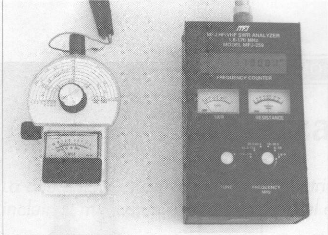
Foto 2. Calibración del ondámetro. En este modelo se utilizó un analizador de antena como generador. Observar la espira de acoplo. Se ha exagerado para tomar la fotografía.
