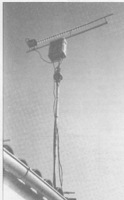
Foto 2. Detalle de la antena y caja del conjunto dispuesta para su uso.
