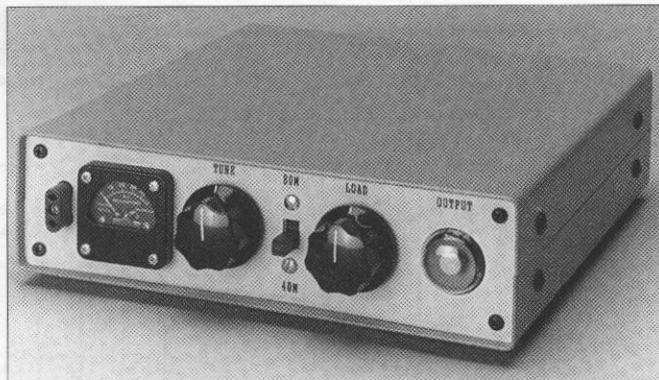
Figura 4. Impresionante transmisor casero construido recientemente por Dave Ishmael, WA6VVL. La caja mide 5,08 cm de alto por 22,86 cm de ancho por 22,86 cm de fondo y tiene un «ojo mágico» como indicador de salida. El interruptor de red se encuentra en el panel trasero. (Foto cortesía de Joe Veras, N4QB)
