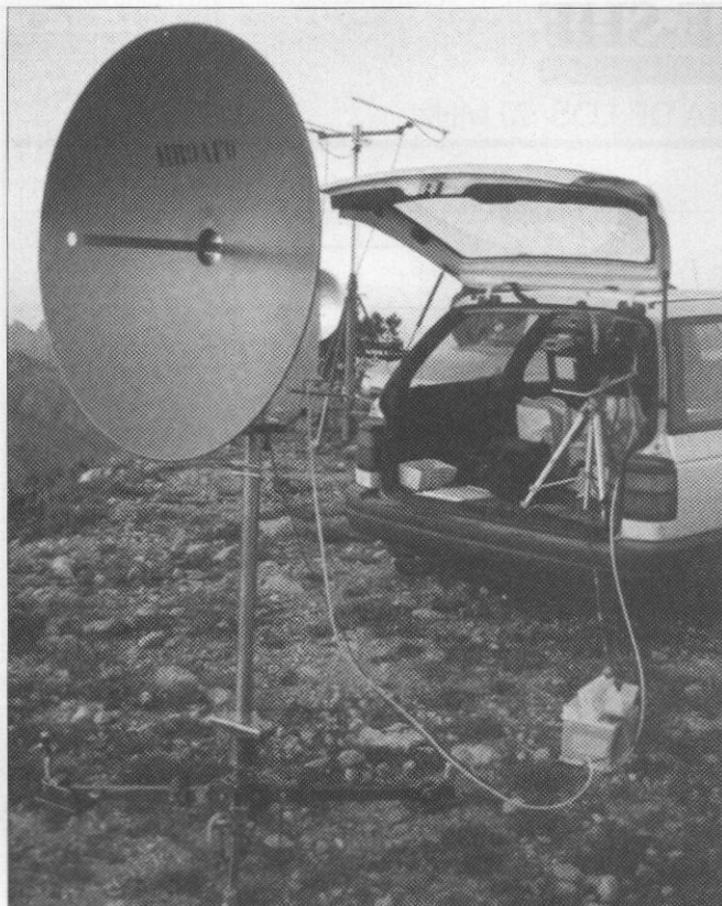
El equipo de 10 GHz ATV de Michel, HB9AFO, en primer plano. Al fondo, detrás de la parábola de 1 m de diámetro con trípode de surplus militar, se puede ver media parábola de Jean-Michel, F6GBQ, y las dos antenas Yagi de 1,2 y 2,3 GHz.
