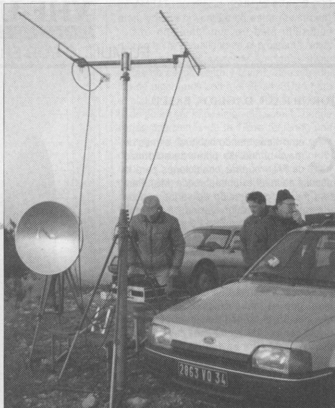
F6GBQ escuchando la baliza de Perpiñán en 1,2 GHz. Se aprecia claramente la parábola de 70 cm de diámetro. La potencia del equipo de 1,2 GHz era 12 W con antena de 25 elementos DJ9BV y en 2,3 GHz, 6 W con 42 elementos tipo DL6WU. En el enlace de HF, F6BCF realizó la geolocalización con la ayuda de un receptor GPS.
