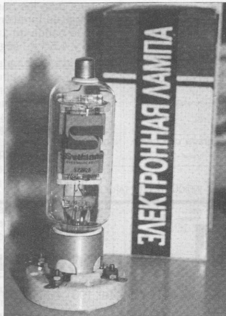
Foto 1. La válvula Svetlana 572B en su zócalo.
